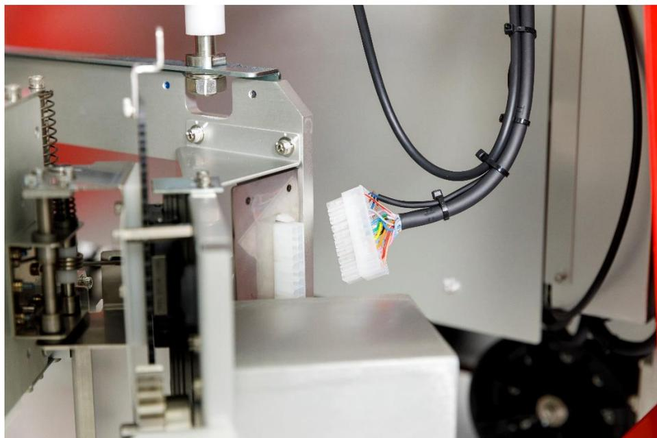
コードの抜き差しで簡単に左右のユニットを分割可能
